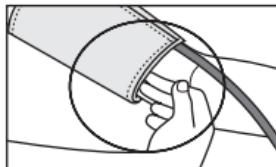
Inserte el tubo del brazalete en el receptáculo para el accesorio del brazalete, en el lado izquierdo de la unidad. Asegúrese de que se inserte firmemente en la unidad principal y de que no haya torceduras en el tubo del brazalete.
